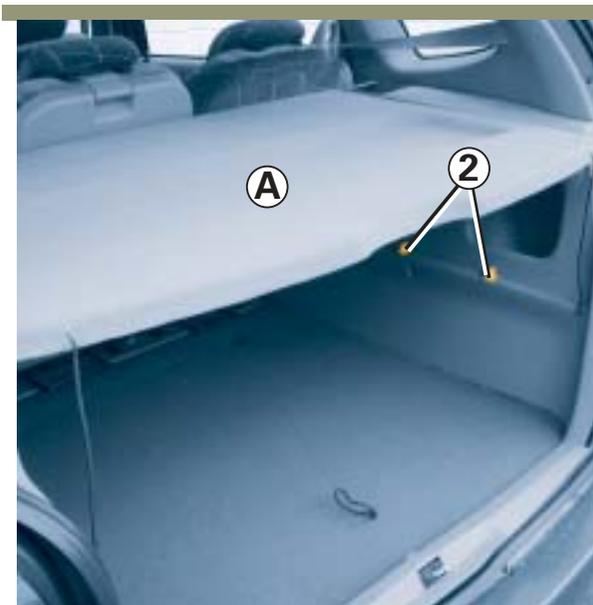
É possível instalar o porta-pacotes numa altura que coincida com a altura dos bancos traseiros com os encostos rebatidos. Para isso, utilize os pontos de apoio **2** existentes em cada lado do compartimento de bagagens.
