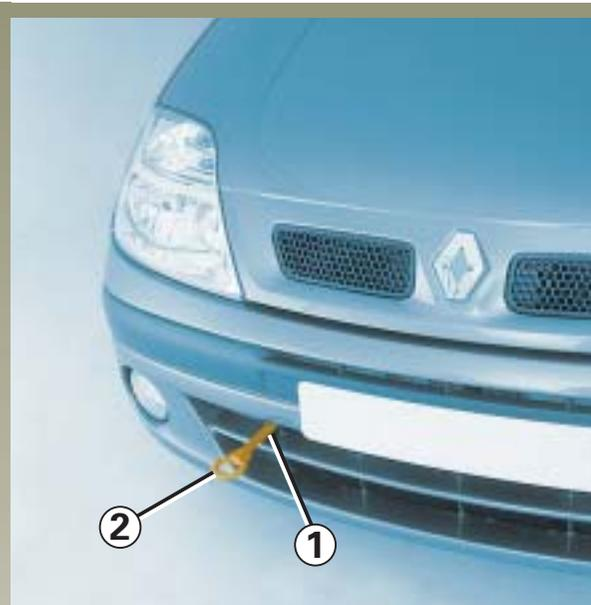
**O volante não deve estar travado; a chave de ignição deve estar na posição «M» (ignição) permitindo a sinalização (luzes, freio, indicadores de direção). À noite, o veículo deve estar iluminado.**
