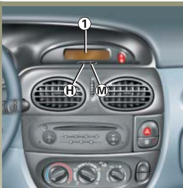
Se houver alguma interrupção no sistema de alimentação elétrica (bateria desligada, fio de alimentação cortado...), os valores indicados deixam de ser confiáveis. Neste caso, é prudente conferir, e se necessário, efetuar a correção com o veículo parado.
