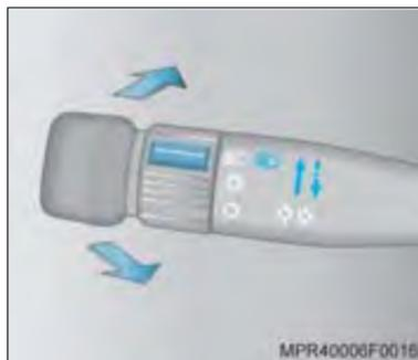
**Farol alto:** acende-se movendo-se a alavanca do sinalizador de direção para frente. A luz indicadora de farol alto
