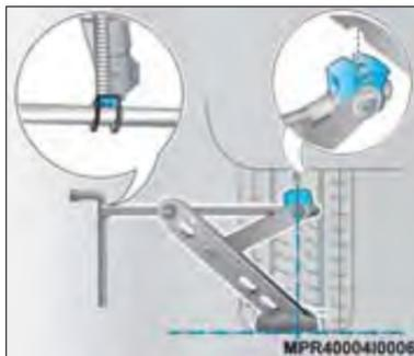
8. Posicione o braço do macaco no encaixe mais próximo da roda a ser substituída, de modo que a garra do macaco envolva a lâmina vertical e encaixe no rebaixo da lâmina.
