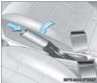
Para liberação do freio de estacionamento, force ligeiramente a alavanca para cima, comprima o botão na extremidade da alavanca (seta) e empurre-a para baixo até que a luz indicadora (D) do painel se apague.
