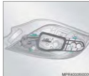
5. Pressione as linguetas de retenção do suporte das lâmpadas e remova o conjunto, puxando-o para fora.
