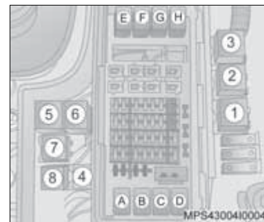
Relés na caixa de fusíveis
