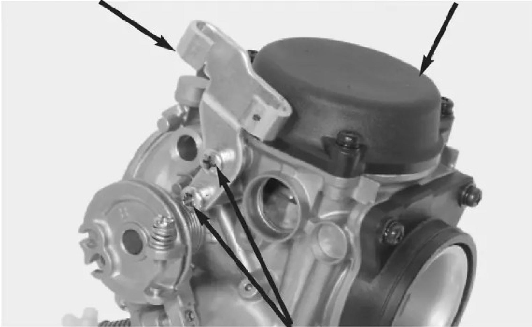
SUPORE DO CABO CARBURADOR Nº 3
