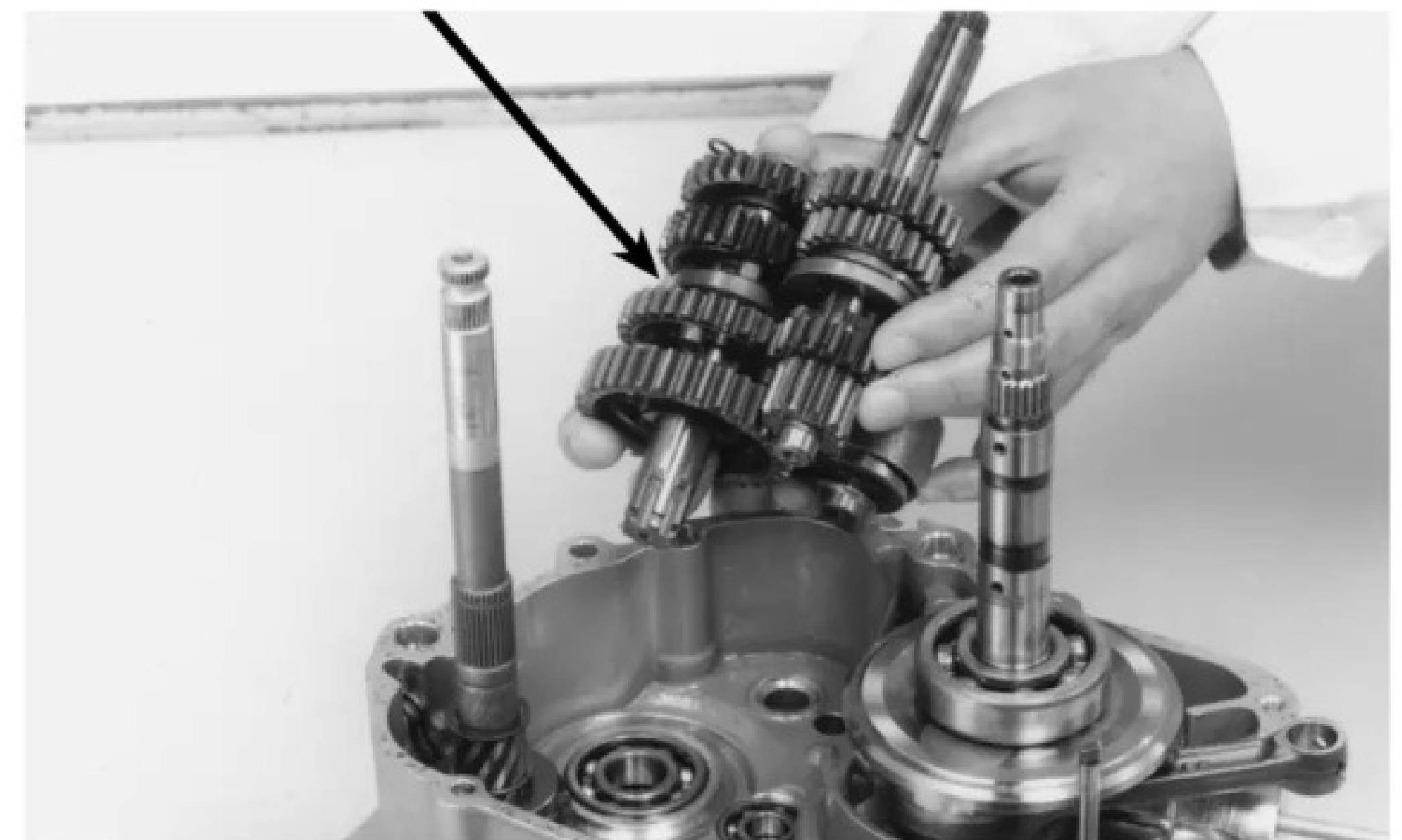
ÁRVORE SECUNDÁRIA ÁRVORE PRIMÁRIA ÁRVORE PRIMÁRIA/SECUNDÁRIA/TAMBOR SELETOR
