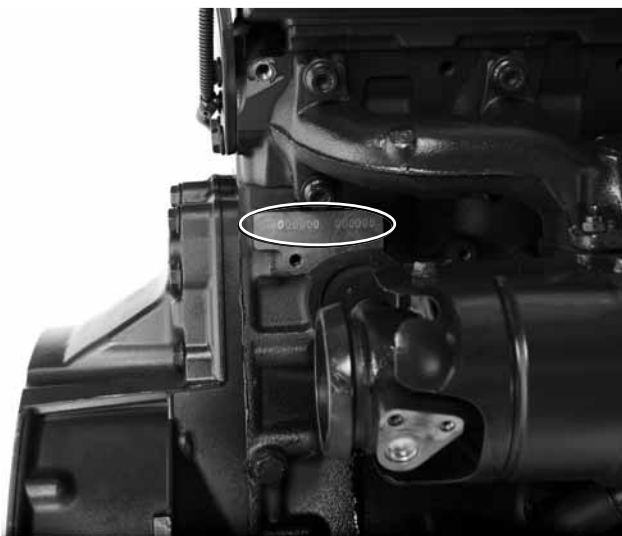
Localização do número do motor no lado direito do motor
