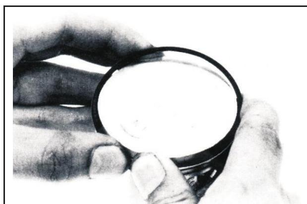
Coloque os respectivos anéis no cilindro, 20 mm abaixo da extremidade. A fim de mantê-los em nível horizontal no cilindro, empurre-os com o pistão.
