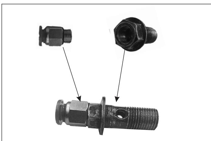
Instale o engate rápido (fêmea) em uma das extremidades da mangueira e, em seguida, conecte-os com o manômetro.
