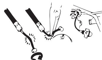
As peças de borracha podem se deteriorar quando velhas e podem ser danificadas por solvente e óleo. Verifique essas peças antes da instalação para ter certeza de que estão em boas condições. Substitua-as, se necessário.
