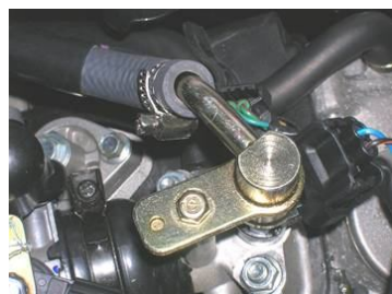
Medição da pressão do combustível prender - injetor
