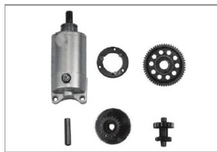
Estrutura do dispositivo de partida elétrica
