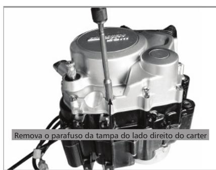
Remova o parafuso da tampa do lado direito do cárter
