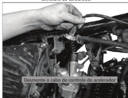
Desmonte o cabo de controle do acelerador
