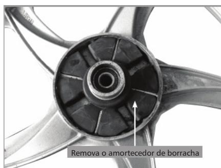
13) Verifique o rolamento do corpo do amortecedor quanto a desgaste e substitua-o se a sua folga radial for excessiva.
