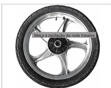
17) Verifique o pneu traseiro quanto ao desgaste. O valor limite para reparo para banda de rodagem do pneu traseiro é de 2,00 mm.
