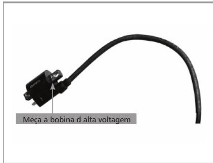
17) Desmonte o medidor e remova o carregador do interruptor de ignição. Meça se o fio de conexão tem bom contato.
