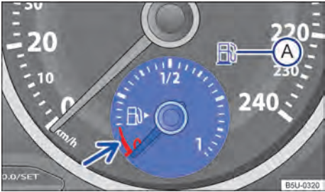
Fig. 18 No instrumento combinado: indicador do nível de combustível (variante 2).
