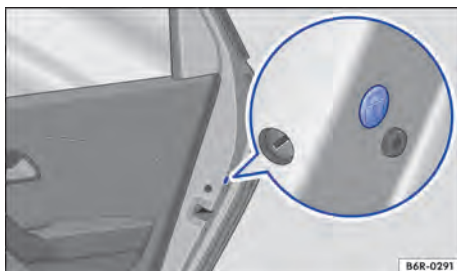
Fig. 60 Na parte dianteira da porta direita: travamento de emergência, coberto por uma vedação de borracha.
