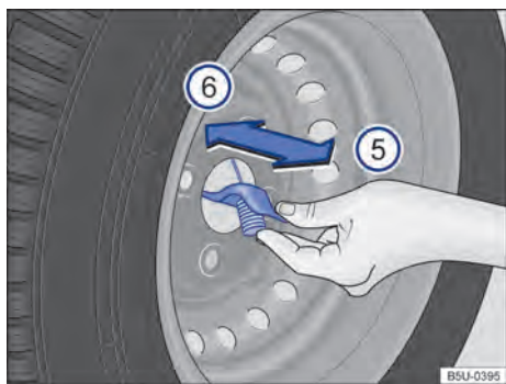
Fig. 193 Na roda de emergência: remover o cabo da roda de emergência.
