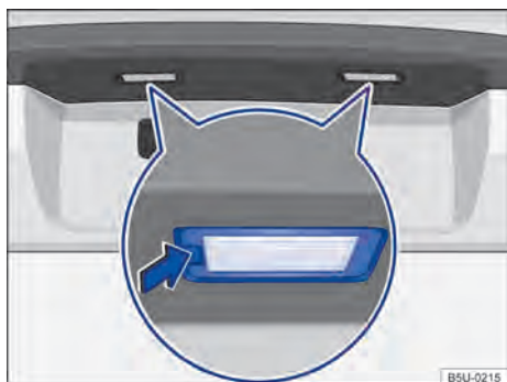
Fig. 166 No para-choque traseiro: remover a lanterna da placa de licença.
