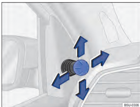
Fig. 87 Nas portas dianteiras: interruptor de ajuste dos espelhos retrovisores externos mecânicos.
