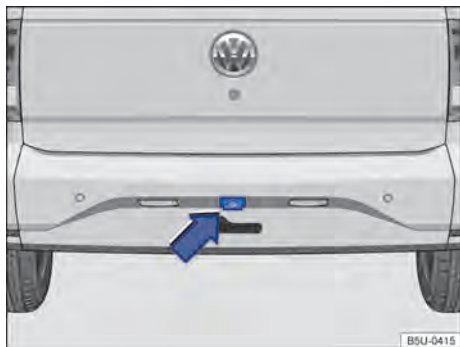
Fig. 113 No para-choque traseiro: local de instalação do assistente de condução em marcha a ré.
