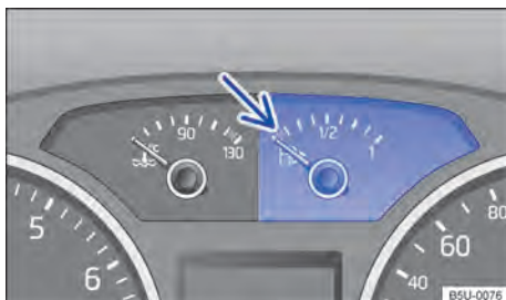
Fig. 19 No instrumento combinado: indicador da reserva de combustível.
