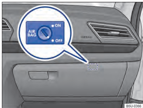
Fig. 45 No porta-luvas: interruptor desacionado pela chave para desligar e ligar o airbag frontal do passageiro.
