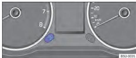
Fig. 82 No instrumento combinado (Nova Saveiro Robust): tecla de regulação da iluminação dos instrumentos e dos interruptores.
