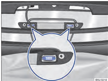
Fig. 169 Lanterna de freio elevada: remover a lâmpada incandescente da iluminação do compartimento de carga.
