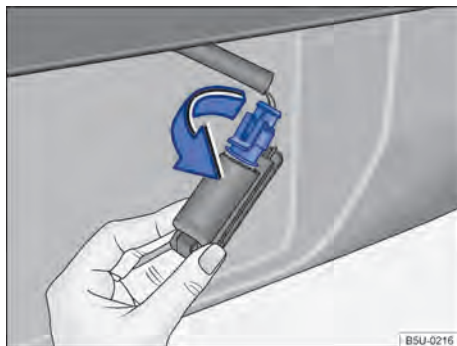
Fig. 167 Lanterna da placa de licença: remover o soquete da lâmpada.
