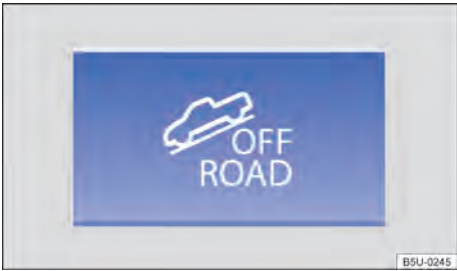
Fig. 106 No console central: botão para ligar e desligar o modo off-road manualmente.
