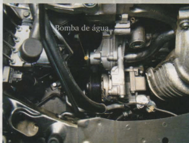
Fig.8 - Localização da bomba de água
