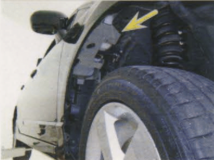
Localização da bomba auxiliar para partida a frio - BPF
