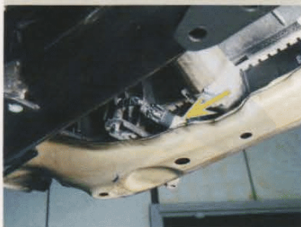
Localização do sensor de temperatura do líquido no radiador - ECT 02
