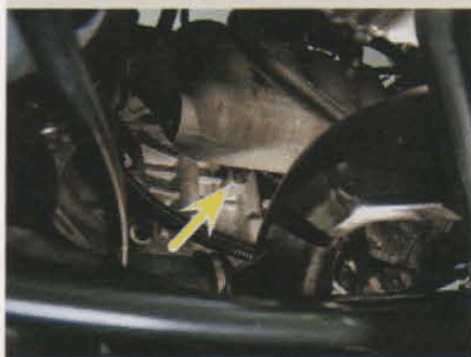
Localização do sensor de detonação - KS
