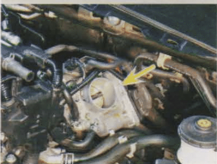
Localização da borboleta motorizada - ETC
