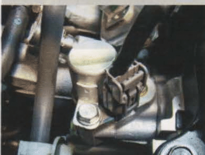
Detalhe da localização da VCB
