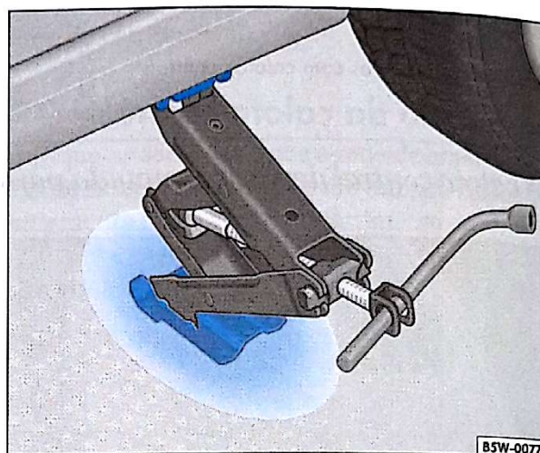
Fig. 125 Macaco colocado na parte traseira, lado esquerdo
