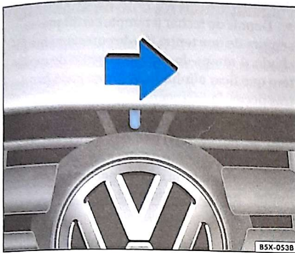
Fig. 106 Detalhe da grade do radiador: trava de segurança para abrir a tampa do compartimento do motor
