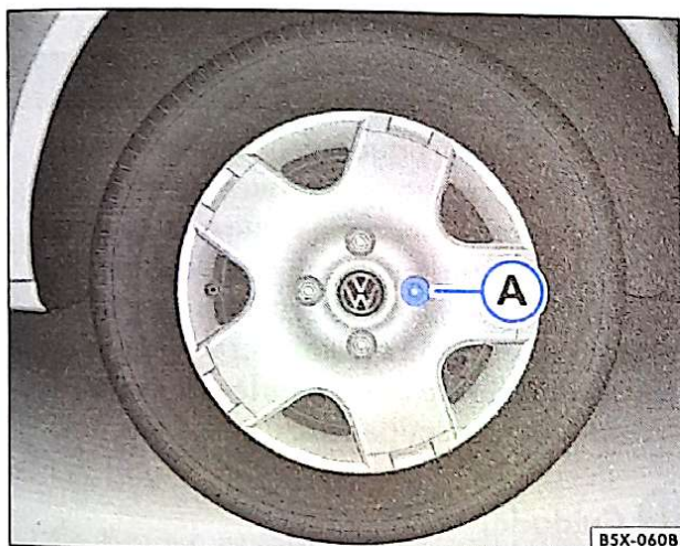
Fig. 126 Sequência de remoção dos parafusos da roda
