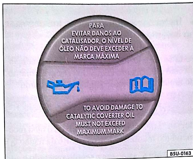
Fig. 109 No compartimento do motor: tampa do bocal de abastecimento de óleo
