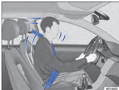
Fig. 25 Condutor protegido pelo cinto de segurança colocado corretamente em uma manobra de frenagem súbita.
