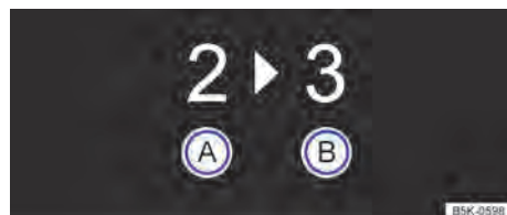
Fig. 80 No instrumento combinado: indicador de troca de marcha.
