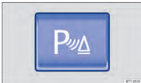
Fig. 100 No rádio: ligar e desligar o auxílio de estacionamento.
