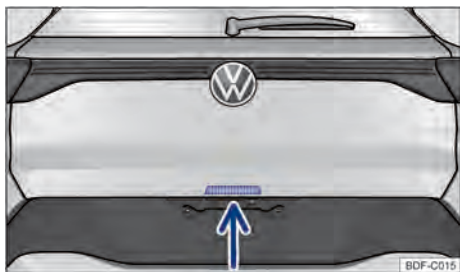
Fig. 57 Na tampa traseira: botão para abrir a tampa traseira.
