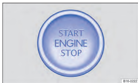
Fig. 83 Na parte inferior do console central: botão de partida para ligar o motor.
