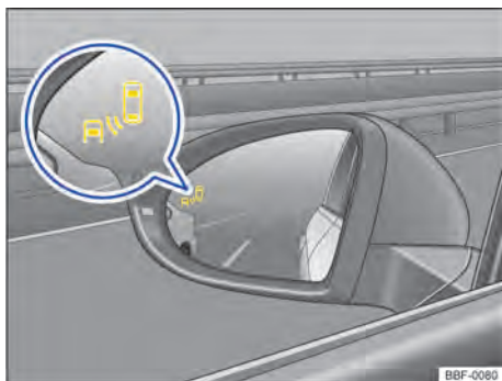
Fig. 98 Nos vidros dos espelhos retrovisores externos: indicador do sensor de "ponto cego".
