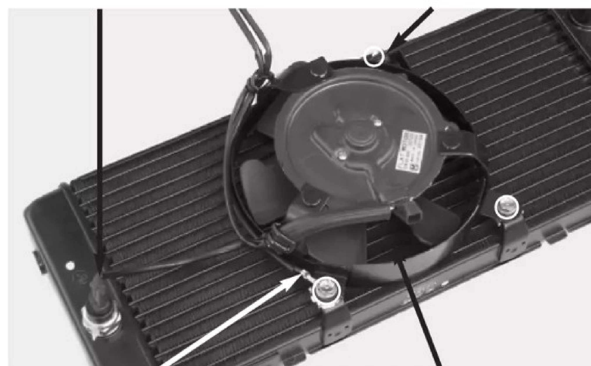
TERMINAL DE ATERRAMENTO
