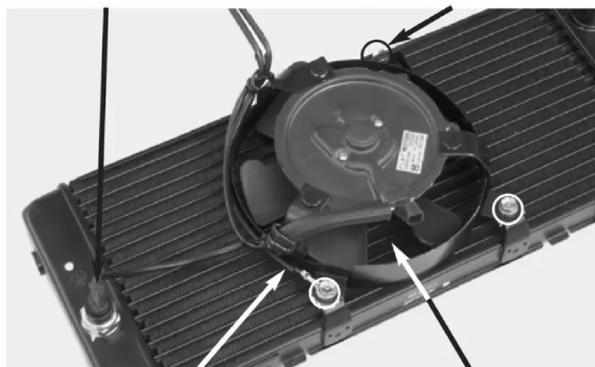
TERMINAL DE ATERRAMENTO
