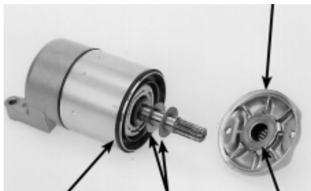
ANEL DE VEDAÇÃO INDUZIDO ARRUELAS DE ENCOSTO CARÇAÇA ARRUELA DE TRAVA
