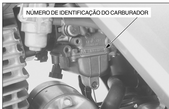
O número de identificação do carburador está gravado no lado esquerdo do corpo do carburador, conforme mostrado.
