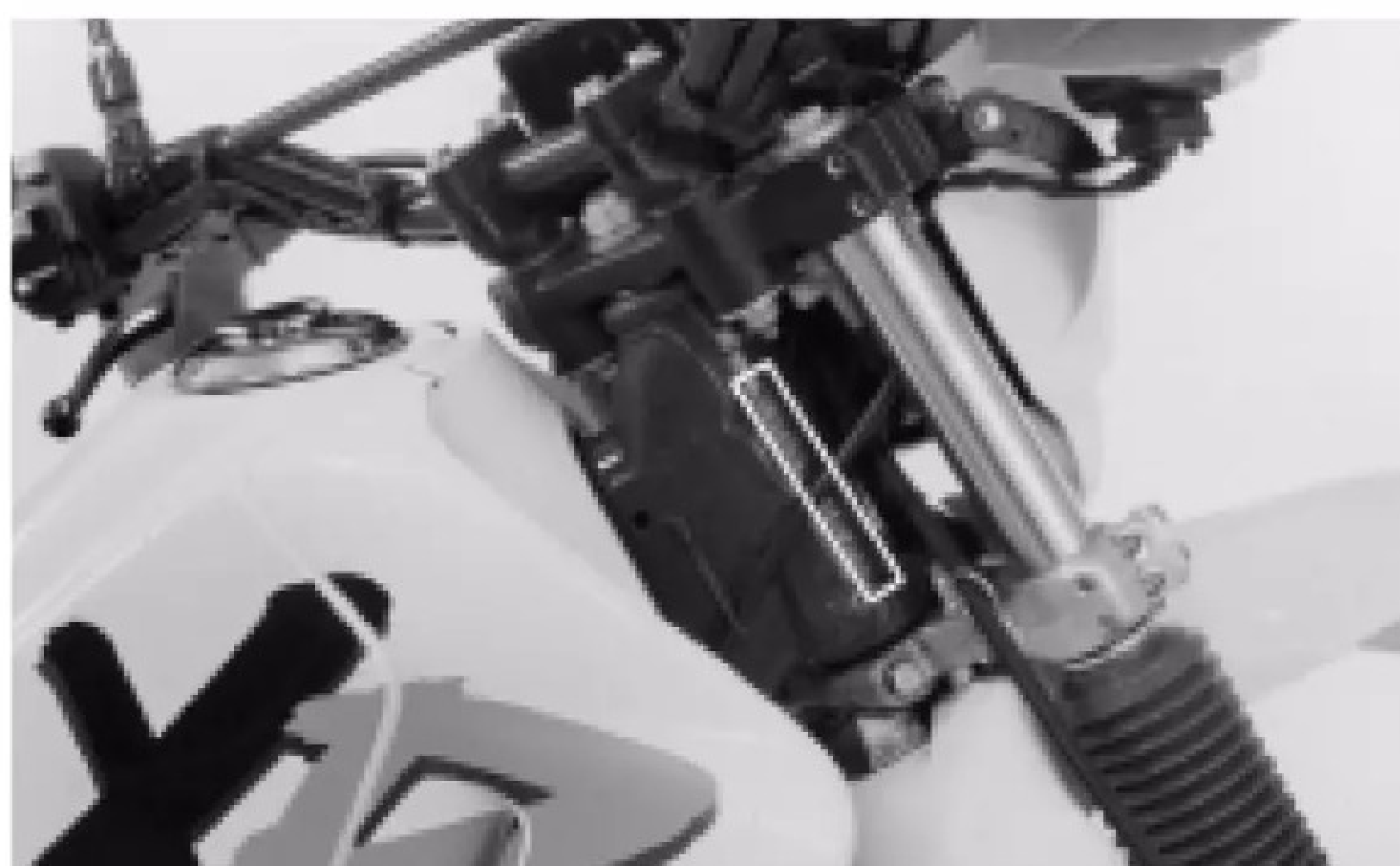
(1) O número de série do chassi está gravado no lado direito do tubo da coluna de direção.
