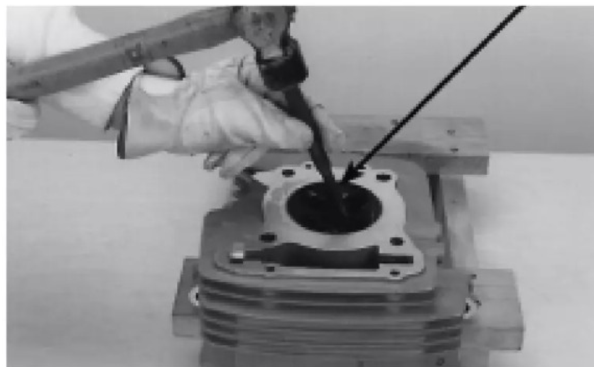
INSTALADOR DA GUIA DA VÁLVULA
