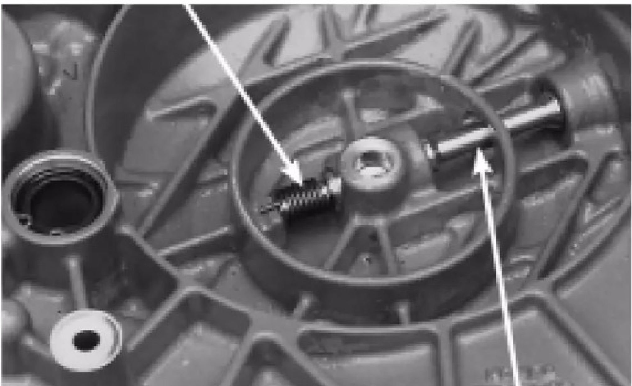
EIXO DO BRAÇO DE ACIONAMENTO DA EMBREAGEM
