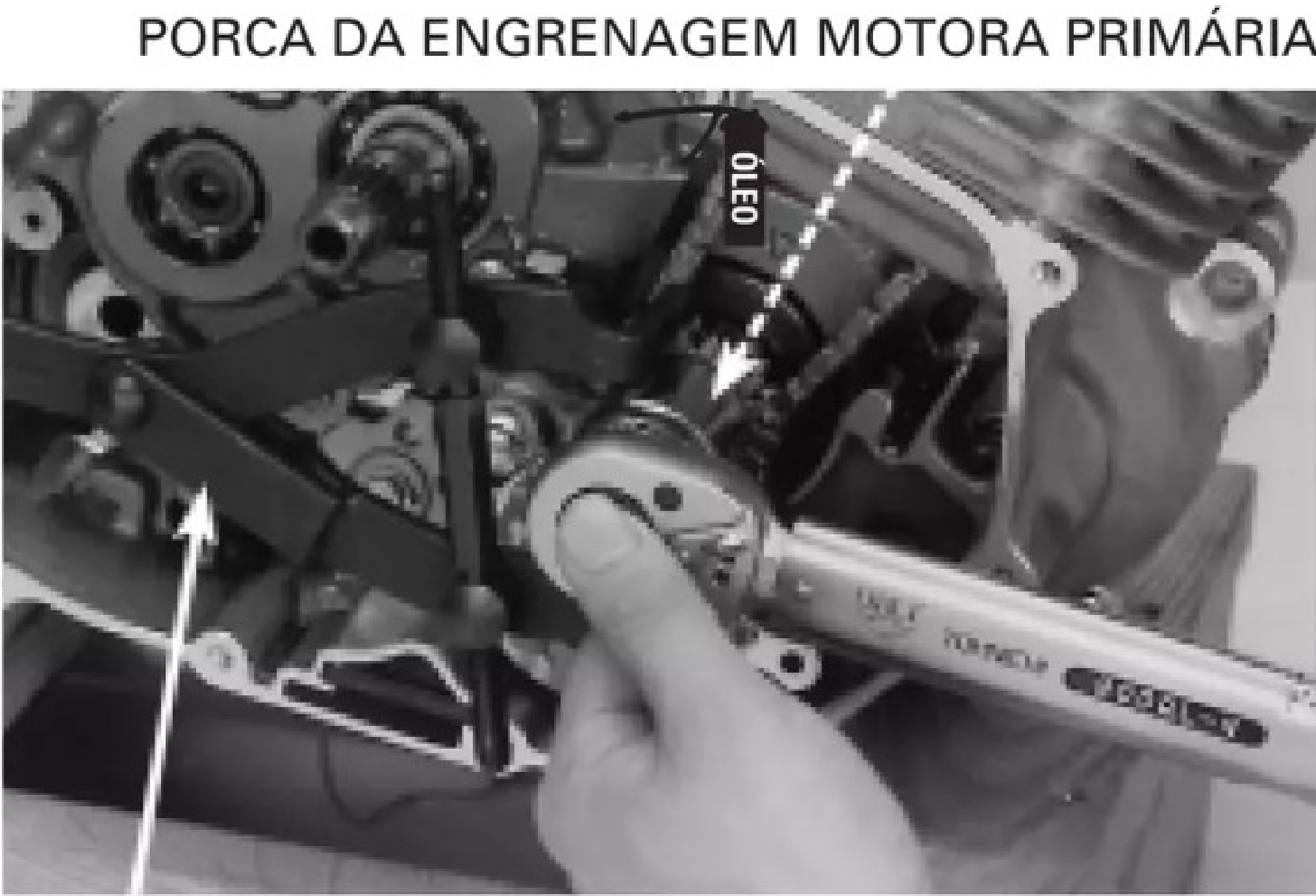
FIXADOR DO CUBO DA EMBREAGEM ARRUELA POSICIONADOR DE MARCHAS PARAFUSO
