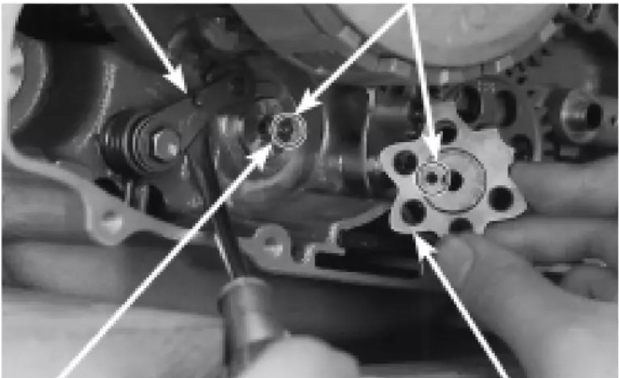
PINO-GUIA EXCÊNTRICO POSICIONADOR DE MARCHAS PARAFUSO
