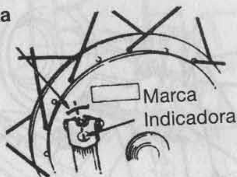
Fig.A - A extensão da marca de desgaste está dentro da especificação.
